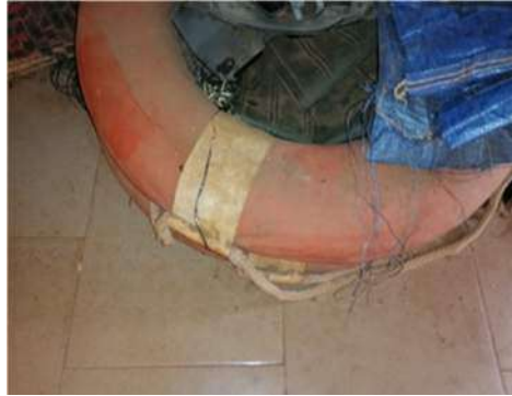
Bouée de sauvetage non installée et en état de dégradation, EDE, mai 2024
